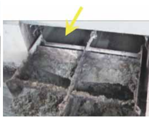
豚舎のスクレーパーの掻きとりが良好な状態
