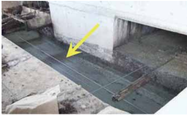
豚舎のスクレーパーの掻きとりが良好な状態
