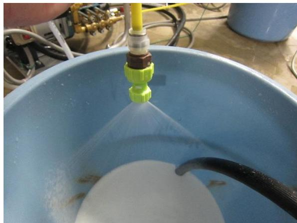
写真 2 乳化液散布用ノズル
