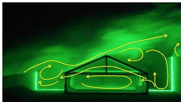
図1 模型による気流の可視化試験
