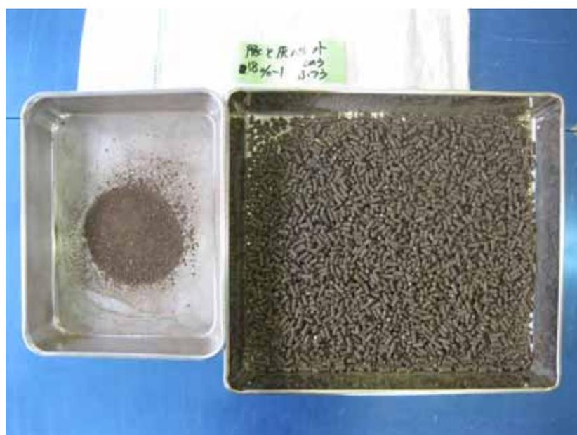
写真8 土のう袋（普通）から取出したペレットと崩壊物（19%）（同上）
