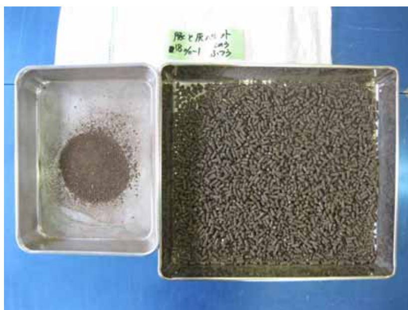
写真8 土のう袋（普通）から取出したペレットと崩壊物（19%）（同上）
