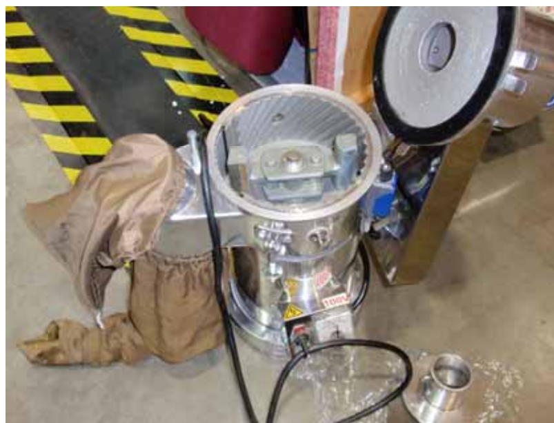
写真1 堆肥原材料の粉碎機
