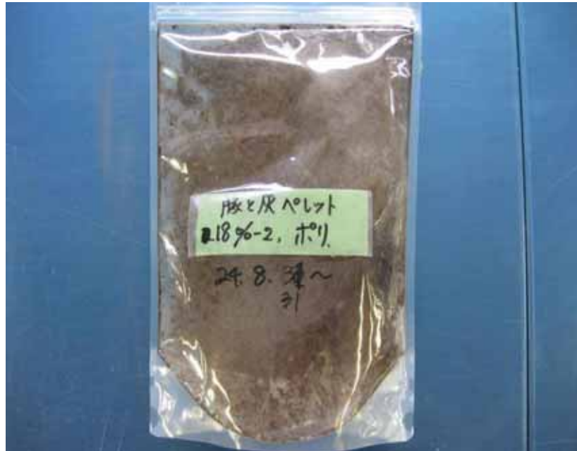
写真6 太陽光の直接照射区における2ヶ月後の保存袋の外観 ペレット堆肥の崩壊物が内壁に付着している（ラミジップ） （豚ふん堆肥と採卵鶏燃焼灰によるペレット堆肥、水分率19%）
