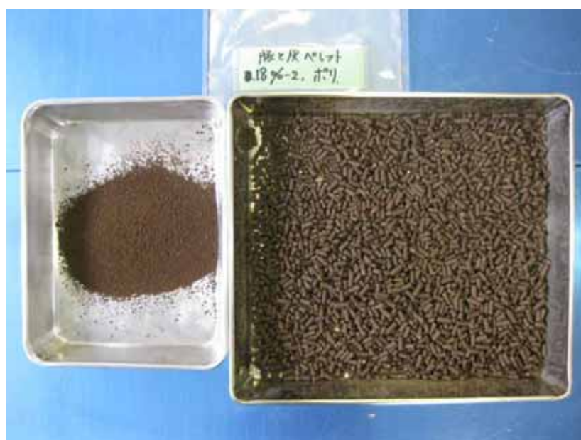
写真7 太陽光照射区のペレット堆肥と内壁への付着物（ラミジップ）
