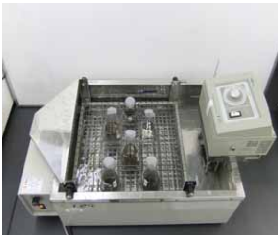
写真4 - 1 く溶性リン酸の抽出操作 写真4 - 2 く溶性リン酸のろ過操作
