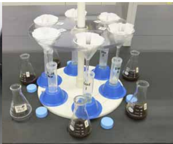
写真4 - 1 く溶性リン酸の抽出操作 写真4 - 2 く溶性リン酸のろ過操作
