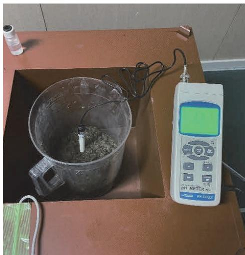
写真 1 脱水ケーキの pH 連続測定の様子
