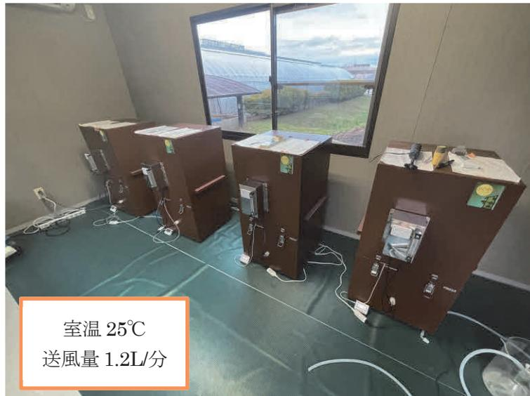
写真2 小型堆肥化試験装置（かぐやひめ）による試験の様子
