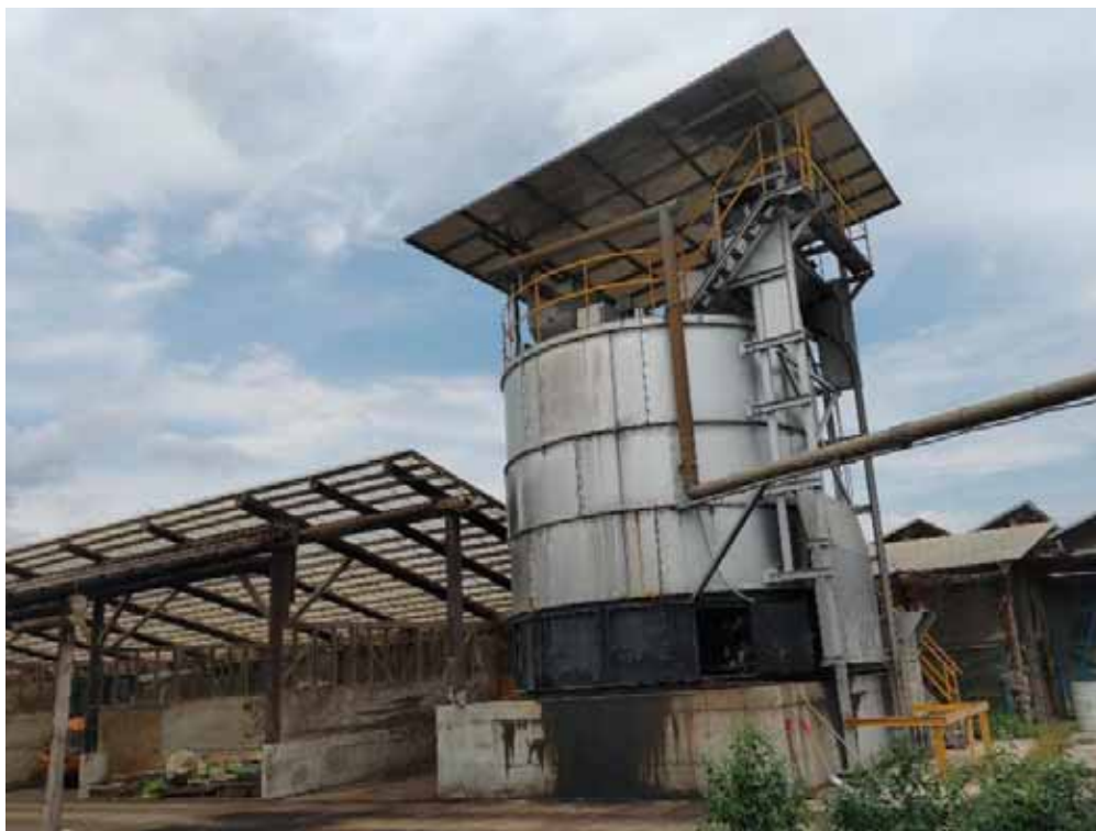
写真1 密閉縦型堆肥化装置外観
