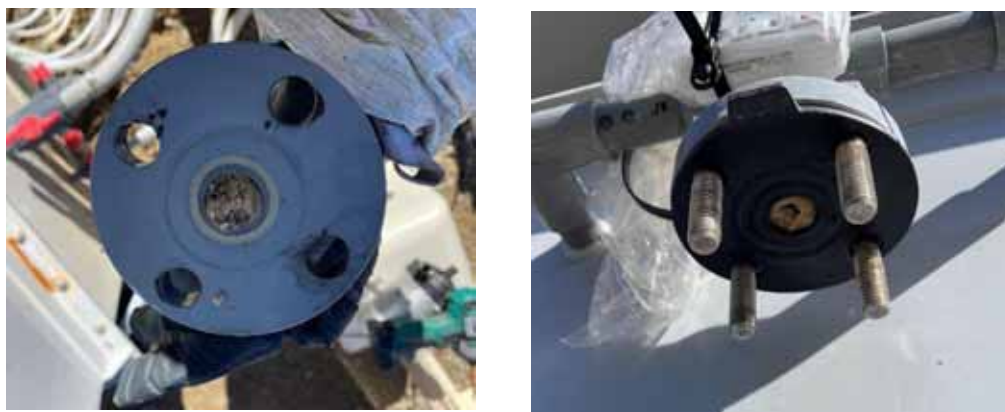
写真3 リン酸マグネシウムアンモニウム (MAP) 等により閉塞した配管類
