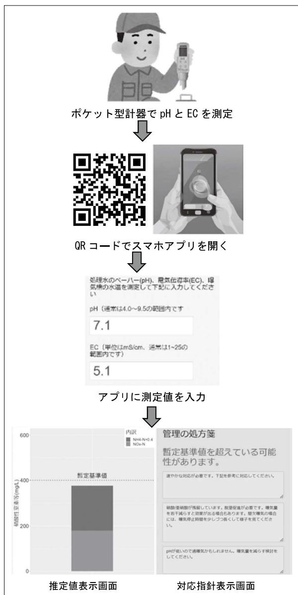
(図5) pH、ECの測定値から硝酸性窒素等濃度を推定する手法
