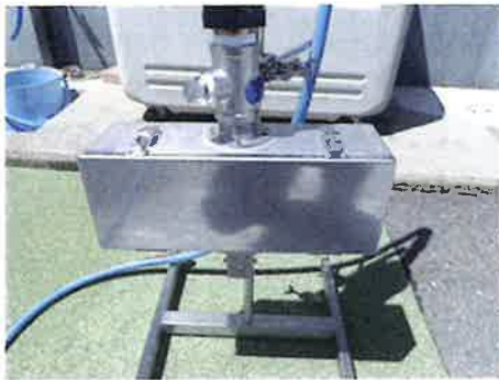
図7 MLSS濃度自動調節装置の濃度測定部（外観と内部構造）
