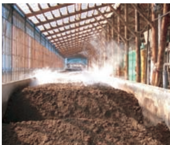
1次処理槽 (幅4m×長さ65m×深さ1.5m)
