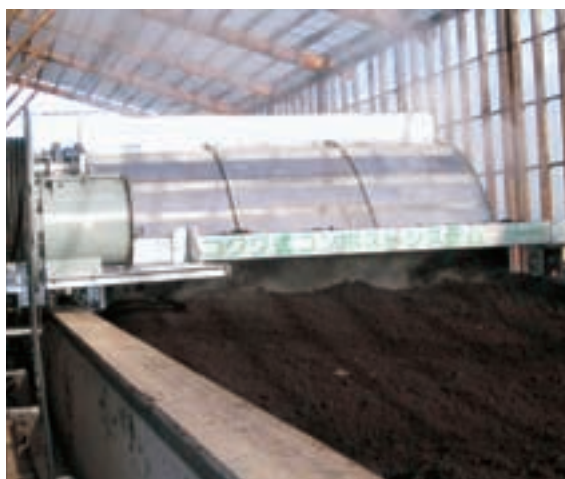
ロータリー式攪拌機 (1日に1回攪拌、温度70 前後まで上昇)
