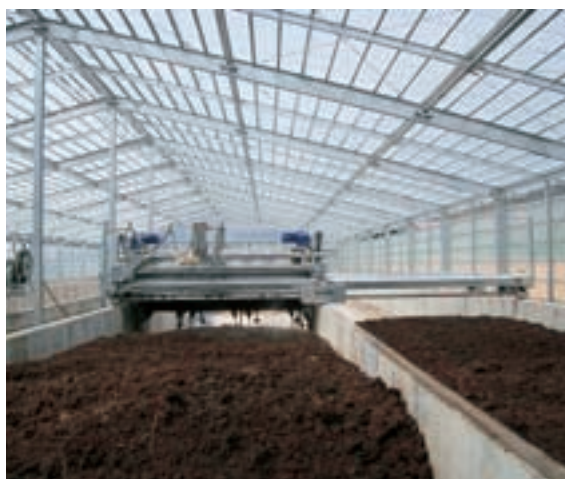
ロータリー式攪拌機 (1台で2レーン攪拌)
