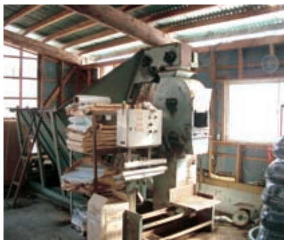
袋詰め機 (秤で計量後シーラーにて袋を閉じる)
