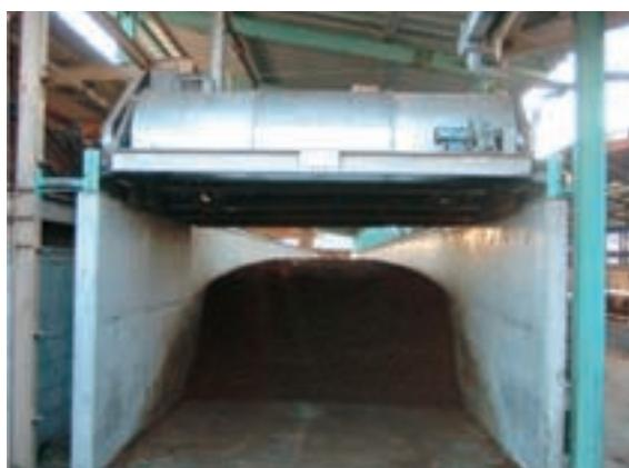
コンベアー式発酵槽（搬出口）
