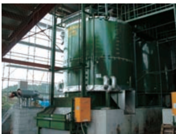
寒冷地仕様コンポ（SK-50K）全体 ふん投入用リフター 出き上り堆肥取出し口
