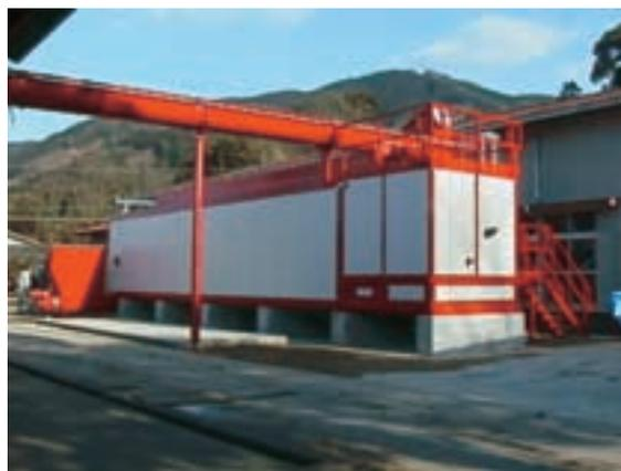
原料移送混合コンベア（手前）
